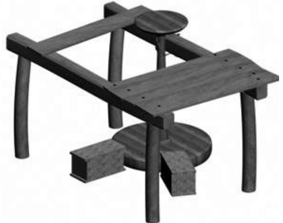
Çizim 1. Esenköy'de kullanılan çömlekçi çarkının çeşitli görünüşleri (çizim:Cafer Özgür)
