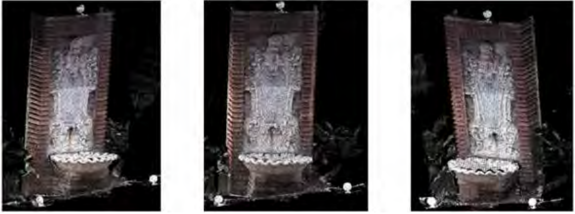
Şekil 1. Laser Tarayıcı ile Taranan Tarihi Çeşmeden Farklı Görünüşler
